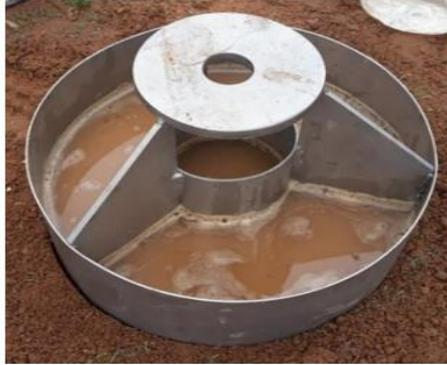
**Figure 39.** Infiltromètre double anneau
