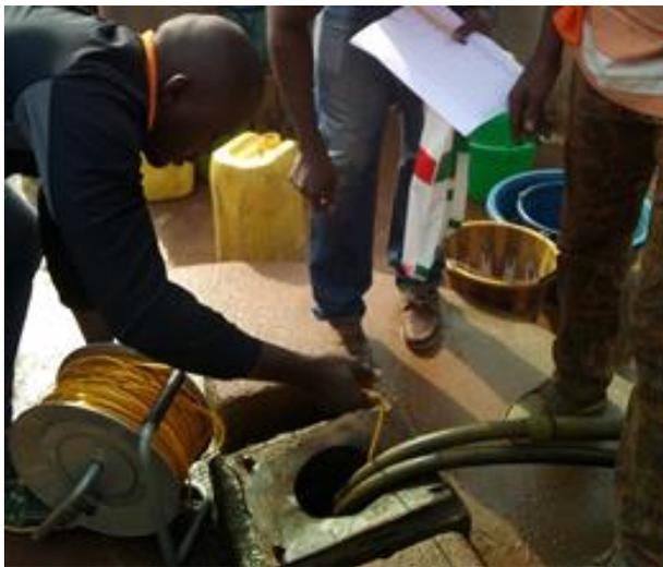
Figure 28. Mesure de niveau piézométrique à Pélézi
