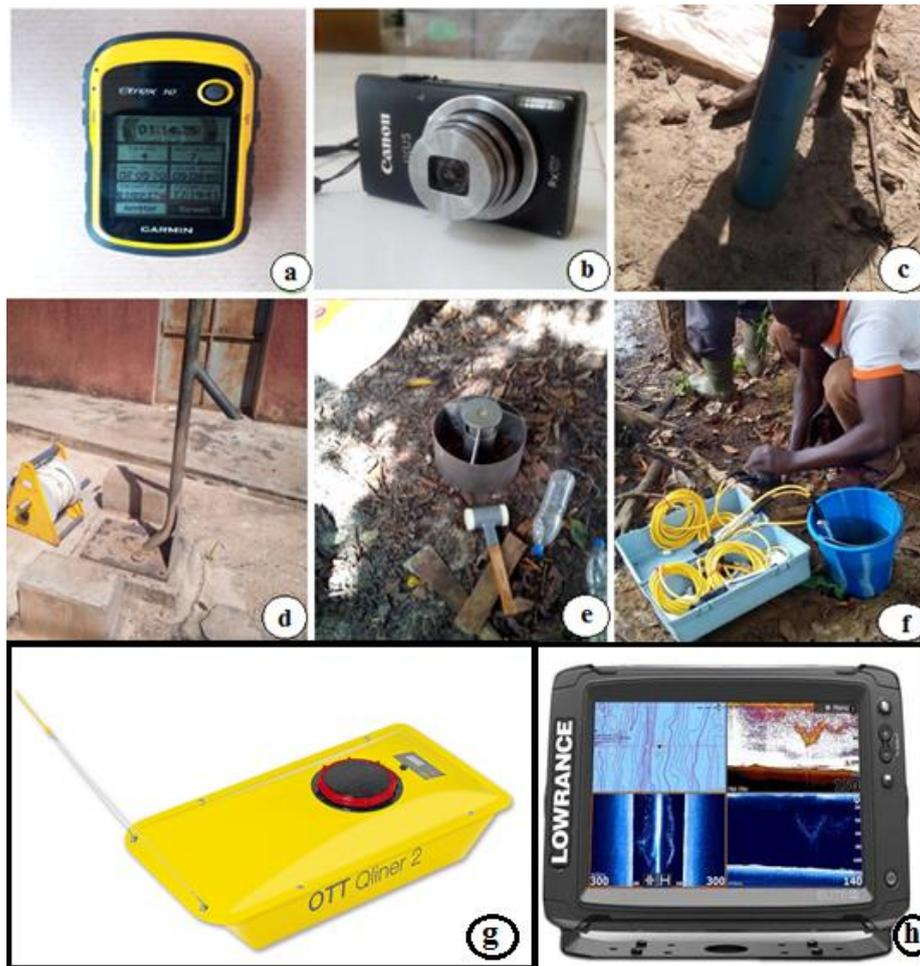
**Figure 23.** Matériel de mesure de terrain : a- GPS de localisation ; b- Appareil photo ; c- Perméamètre de Cheng ; d- Sonde piézométrique ; e- Infiltromètre double anneau ; f- Multiparamètre ; g- ADCP de type OTT Qliner 2 ; h- Eco-sondeur
