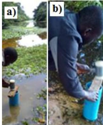
**Figure 46.** Dispositif de détermination de la conductivité hydraulique des sédiments du lit de la rivière : a) : site de la station hydrométrique 2 ; b) : site de la station hydrométrique 1
