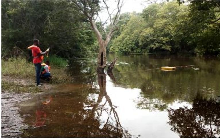
**Figure 43.** Mesure de débits sur la rivière Lobo à la station hydrométrique 2
