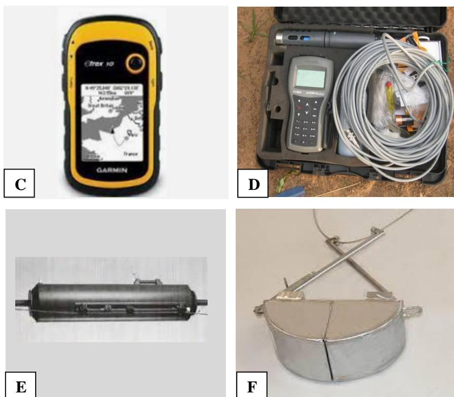
(C) GPS de type Garmin eTrex 10, (D) Multiparamètre de marque HANNA-HI9829, (E) Bouteille de Niskin et (F) Benne Van Veen.
