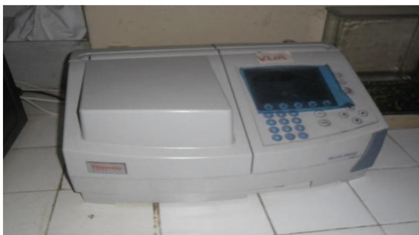
**Figure 14** : Spectrophotomètre UV-visible type Helios Omega.
