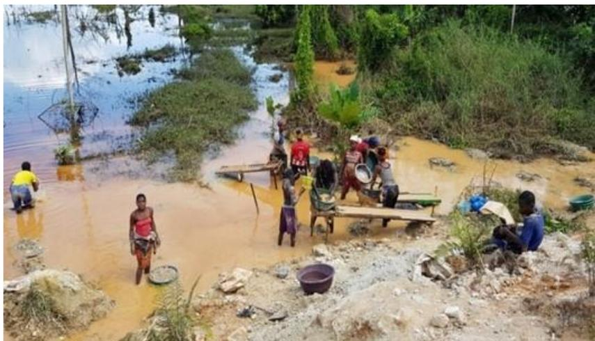
Figure 3: Lavage du minerai et rejet de sédiments dans le Cavally sur un site d'orpaillage (Département Sûreté & Hué, 2018).
