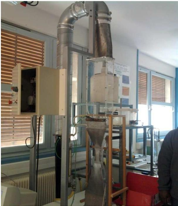
**Image IV.3 Venturi et système de soufflerie**
