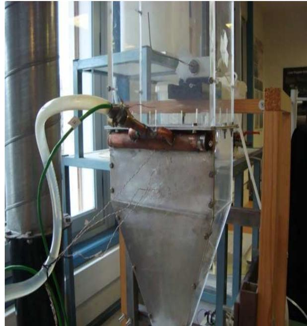
Image IV.2 Système d'injection d'eau et thermocouples
